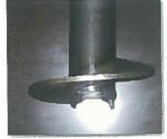
先端刃と共に溶接して完成
